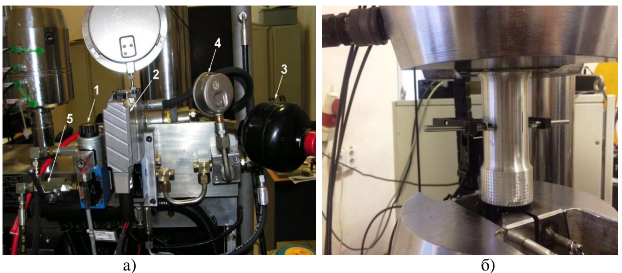
Рис. 4.2.17. Сервогидравлическая система высокого давления (а) и измерение окружных перемещений при циклическом внутреннем давлении поперечным экстензометром (б)
