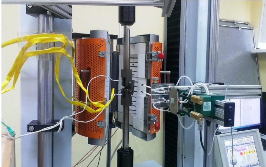
Рис. 2.3.8. Навесная трехзонная печь для испытаний компактных образцов при высокой температуре
