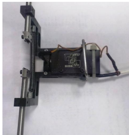
Рис. 2.3.3. Экстензометры поперечных деформаций Vi-06-451 и MTS 634-31E-24
