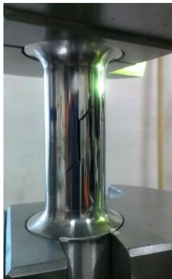
Рис. 2.6.3. Траектория развития трещины при кручении для (а) поперечного и (б, в) продольного расположения исходного надреза
