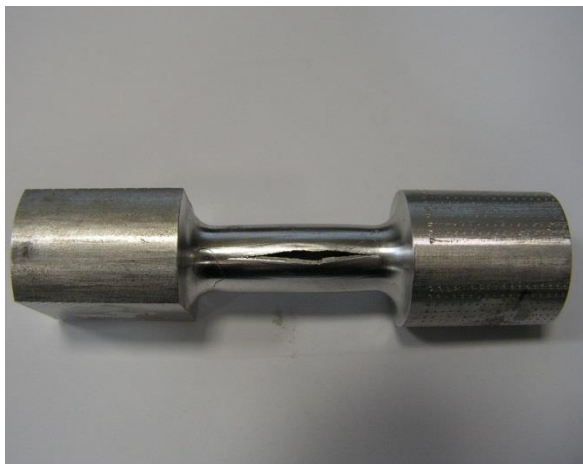
Рис. 4.1.2. Виды разрушения гладкого (а) и надрезанного (б) образцов при испытаниях на внутреннее давление
