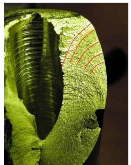
Рис. 2.6.3. Траектория развития трещины при кручении для (а) поперечного и (б, в) продольного расположения исходного надреза
