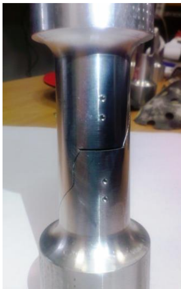
Рис. 2.6.3. Траектория развития трещины при кручении для (а) поперечного и (б, в) продольного расположения исходного надреза
