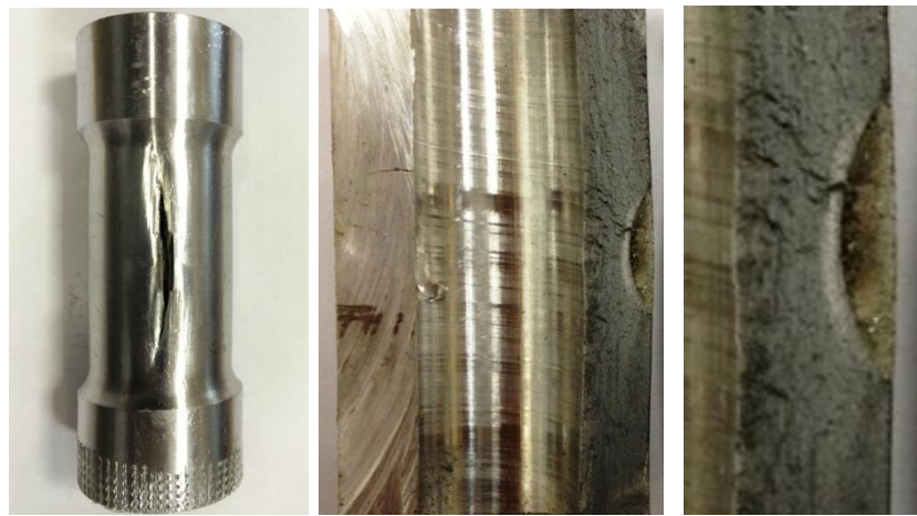
Рис. 4.2.18. Поверхности разрушения полых цилиндрических образцов с продольным надрезом при циклическом внутреннем давлении
