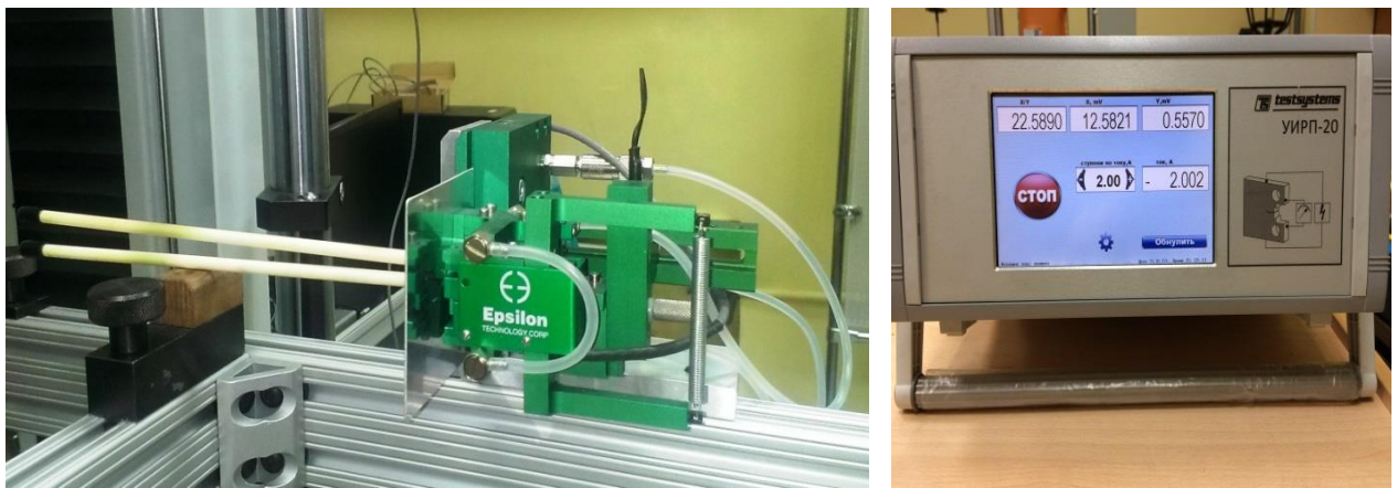
Рис. 2.3.9. Устройства регистрации роста трещины при высокой температуре
