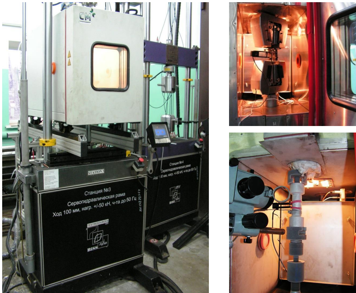
Рис. 2.3.7. Сервогидравлическая испытательная установка с климатической камерой для испытаний образцов при пониженных и повышенных температурах
