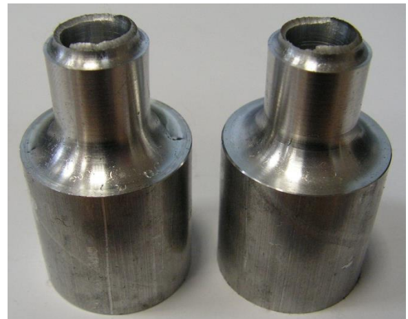
Рис. 4.1.2. Виды разрушения гладкого (а) и надрезанного (б) образцов при испытаниях на внутреннее давление
