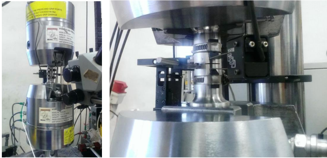
Рис. 2.3.6. Измерение длины трещины микроскопом на внешней поверхности образца и датчики раскрытия трещины в продольном и поперечном направлении
