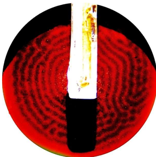
Рисунок 1.13. Конвективные структуры при f_{\text{rot}} = 0.5 об/с, \Theta = 3.4 °С. Управляющие параметры: Ra = 6 \cdot 10^3 , \omega_{\text{rot}} = 25.5 \pm 0.5 , k = 4.4 \pm 0.4
