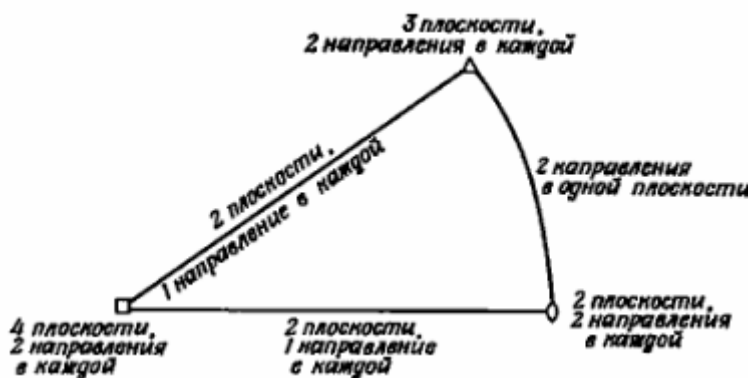
Рис. 5.2.1. Действующие СС в ГЦК-кристаллите при особых ориентировках [154]
