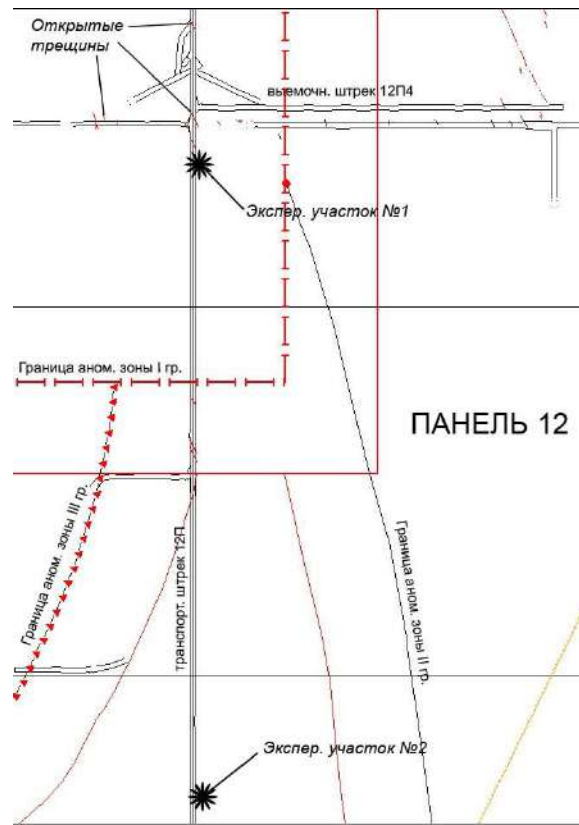
Рис. 5.4. Схема расположения экспериментальных участков на плане горных выработок по пласту КрII панели № 12 (рудник СКРУ-3 ПАО «Уралкалий»)
