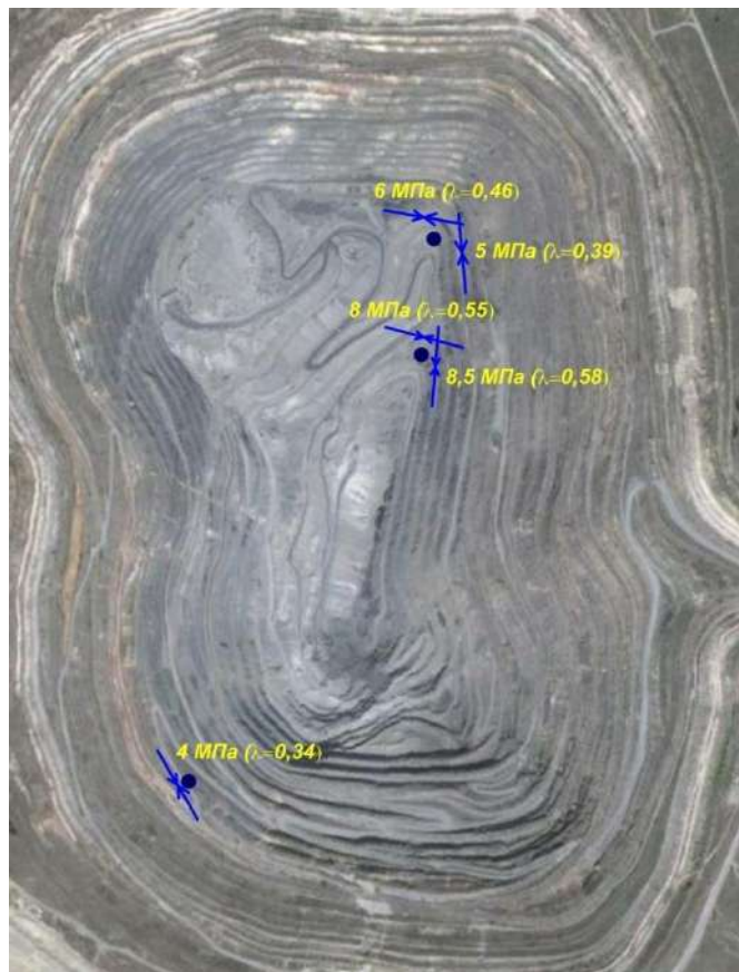
Рис. 5.11. Результаты измерения горизонтальных напряжений в бортах Сарбайского карьера
