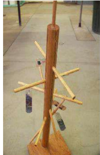
Рис. 1.22. Схема выбуривания образцов из керна в 6-ти направлениях [34]
