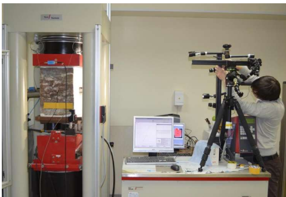
Рис. 2.17. Бесконтактная трехмерная оптическая система «Vic-3D, Correlated Solutions»
