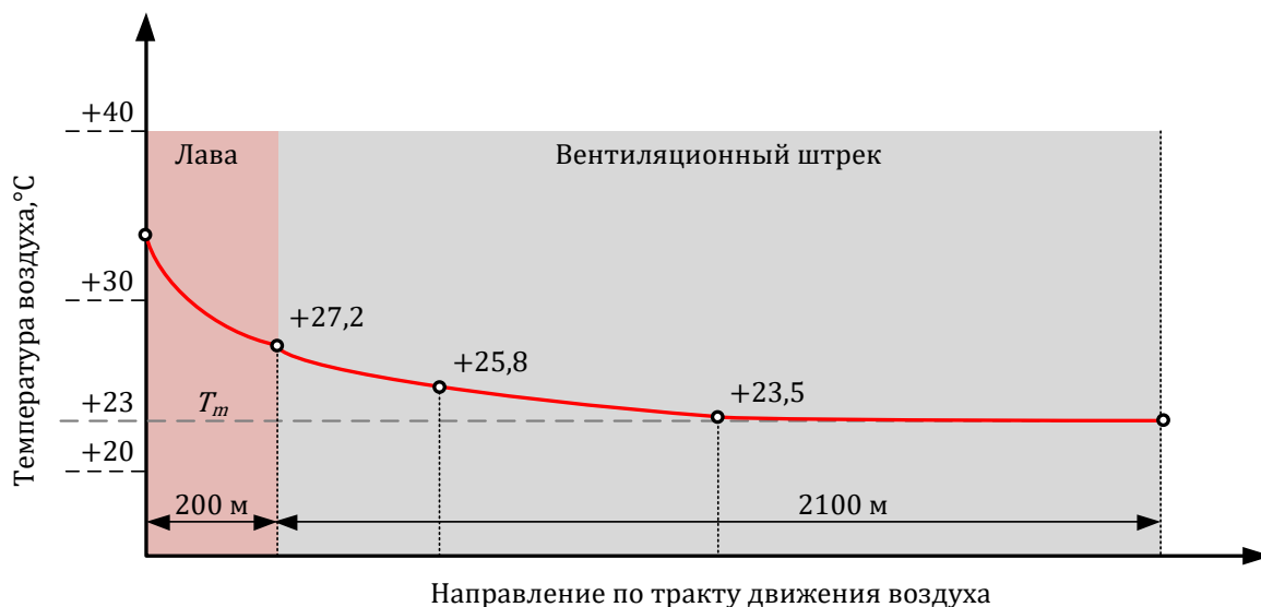
Рисунок 4.4 — Результаты экспериментального измерения температуры воздуха при его движении по лаве и панельному вентиляционному штраку
