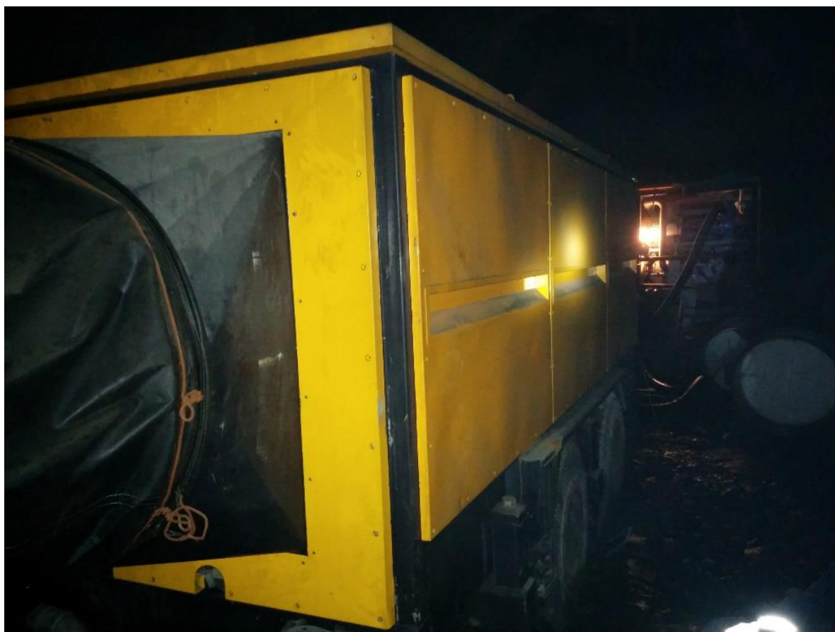
Рисунок 6.8 — Фотоснимок системы кондиционирования КШР-350Н, установленной в выработке РО-23 юг, на участке между РШ 23-29-1 и ТШЛ-36
