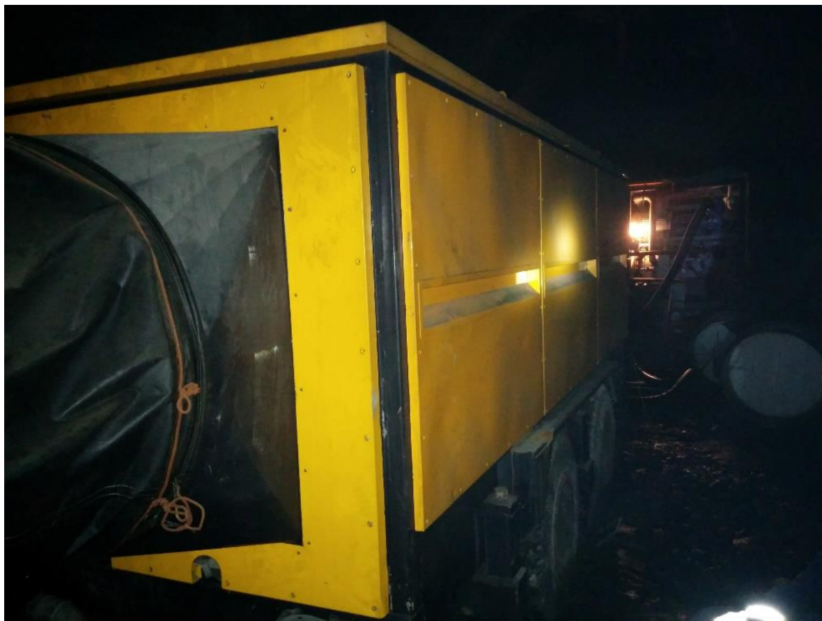
Рисунок 9 — Разработанная система кондиционирования КШР-350Н, установленная в руднике «Таймырский».
