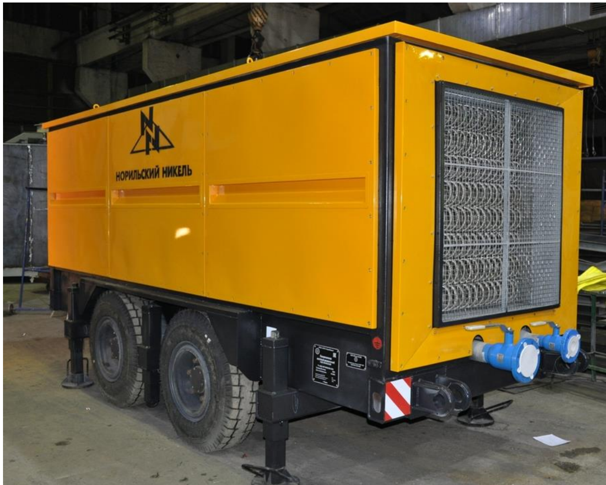
Рисунок 7 — Разработанный шахтный теплообменный аппарат
