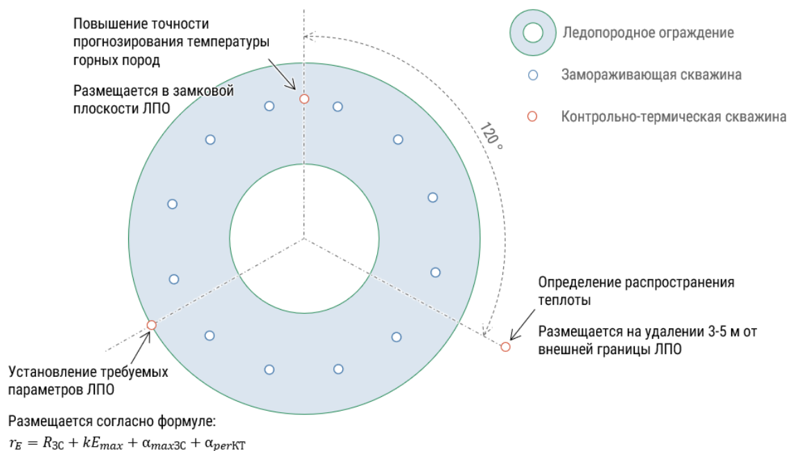
Рисунок 4.15 — Схематичное представление мест заложения контрольно-термических скважин
