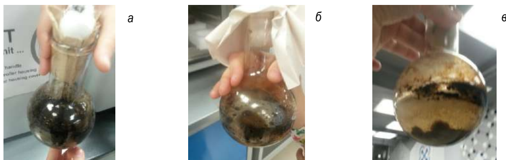
Рис. 7. Эксперимент по биологической деструкции нефти бактериями. Через 2 месяца пленка нефти разрушена. а) нефть, б) через месяц, в) через 2 месяца
