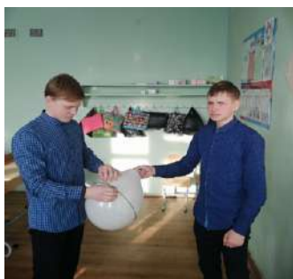
Рис. 2. Определение дыхательного объема легких учащихся при помощи самодельного спирометра
