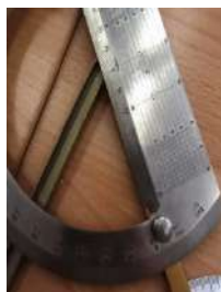
Рис. 5. Система измерения углов между гранями и ребрами в кристаллах медного купороса
