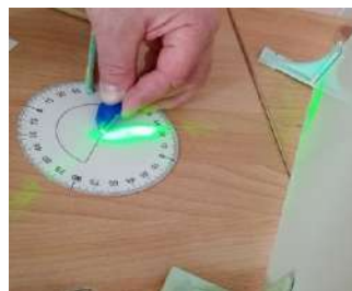
Рис. 6. Определение абсолютного показателя преломления кристалла медного купороса
